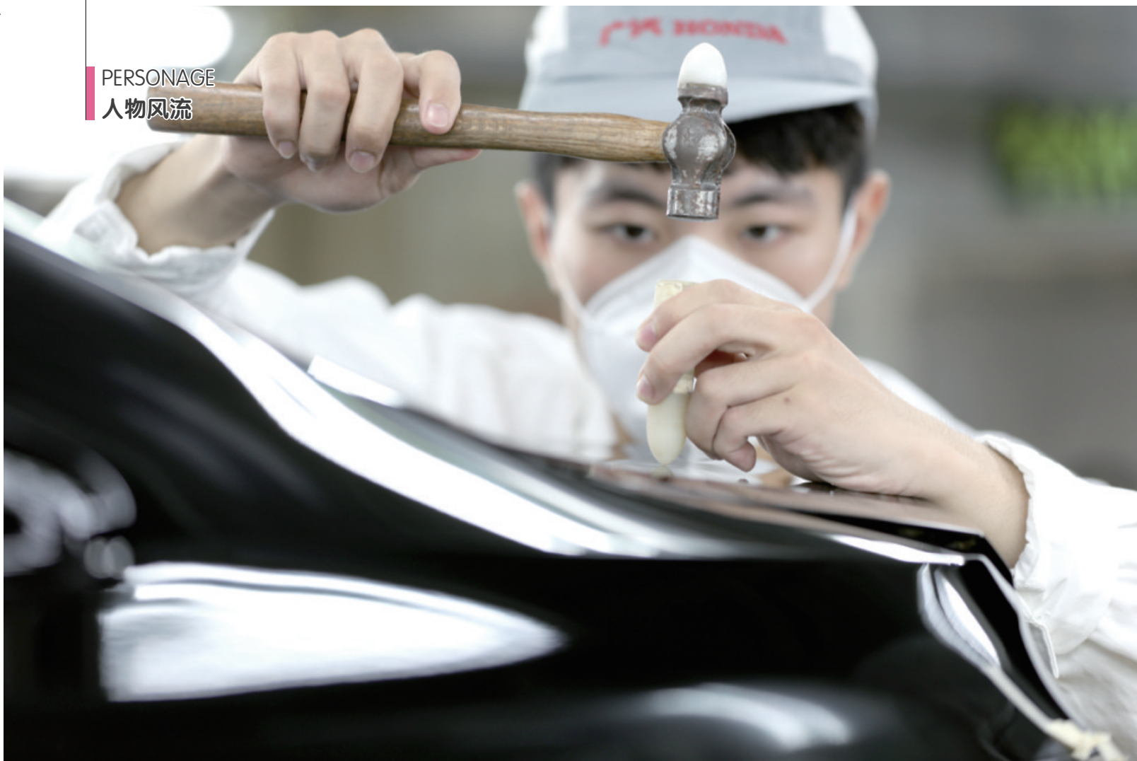
曾俊钦用胶凿对带漆面板的凸起部分进行返修
