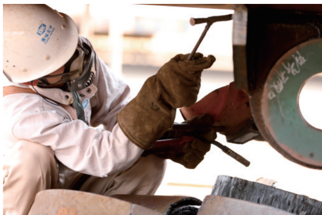
↑ 罗子盛敲除船舱表面的烧焊渣
